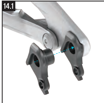
■ Fig. 14.1: Monter UDH-hengerenheten i dropouten.
