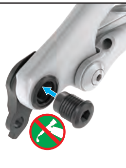
■ Fig. 14.3: Sett på plass UDH-skiven, og før deretter UDH-bolten gjennom skiven og inn i hengeren.
